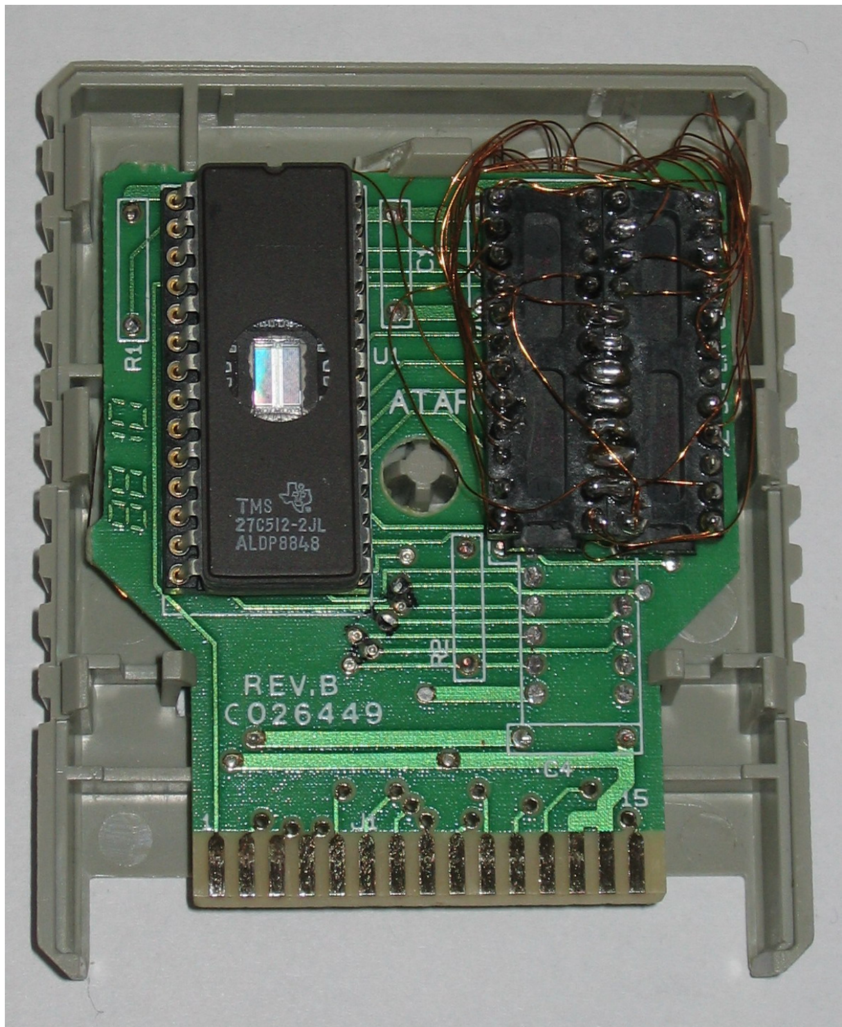
XEG's Gehäuse mit Platine und allen Bauteilen
