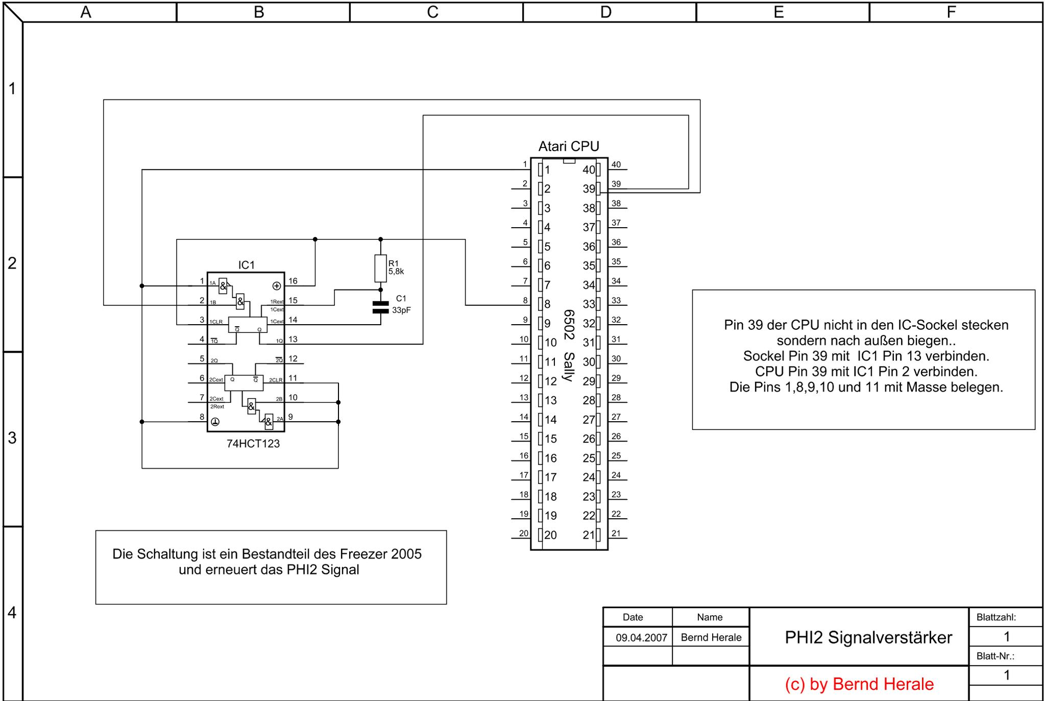
Pin 39 der CPU nicht in den IC-Sockel stecken
